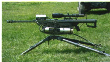
安装在TRAP T-250型 遥控瞄准装置上试验的M82A1
