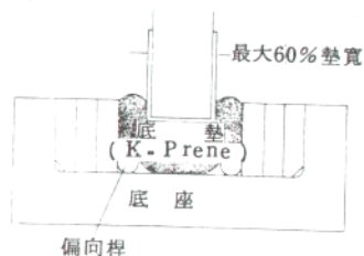
圖 12 基本 U 型成形底模。用端帽限制該模墊。
