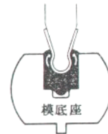
圖 21 在一標準模底座上側壓形成法。
