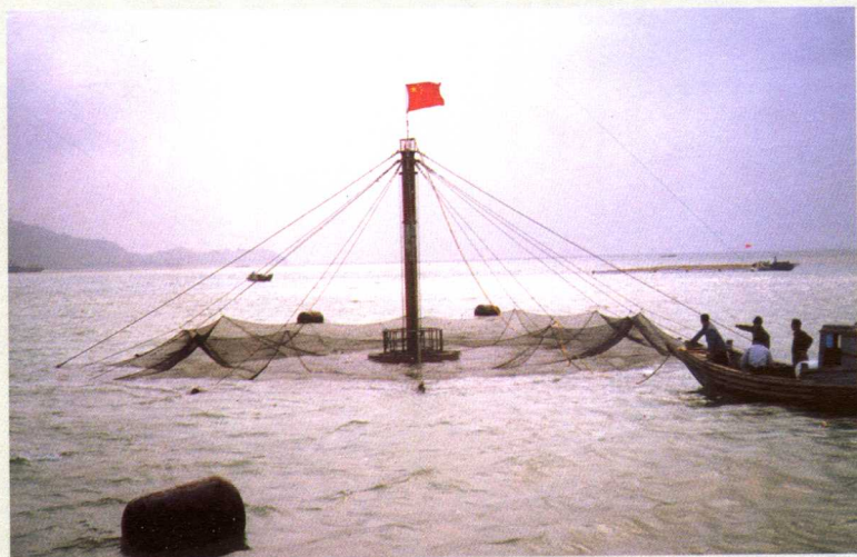
杭州飞鹰海洋养殖设备公司与浙江省海洋水产研究所合作研发的碟形升降式网箱
