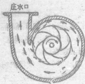
图10 螺旋式抽水机
