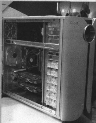
● 富士康展示的4块GeForce 7800 Quad SLI平台，主板基于nForce4 SLI X16芯片组，具有两条PCI-E x16插槽，两块显卡共享其中一条插槽。
