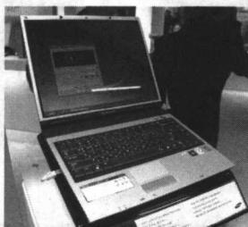
● 基于Intel Centrino Duo平台的三星R65笔记本电脑，采用NVIDIA最新的GeForce Go 7400/7600移动版图形核心和“Super Bright Gloss”15英寸宽屏LCD，具有强大的3D和视音频娱乐性能，此外它还具备802.11a/b/g和蓝牙2.0无线网络功能。
