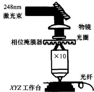
图 1-7 掩膜投影成栅法原理图
