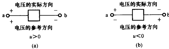
图 1-6 电压参考方向与实际方向的关系
