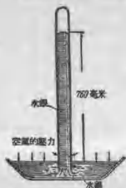
圖 1 管中水銀不會落下，因為空氣正壓在槽中的水銀面上。
