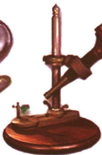
▶ 18世纪使用最广泛的显微镜是卡夫显微镜。
