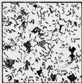
圖 2 石膏的結晶——在硬化過程中的臨界點經過擾動。注意其中結晶的疏鬆交錯。（根據 Luck 氏）
