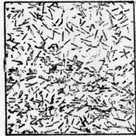
圖1 石膏的結晶——在硬化過程中沒有經過擾動。注意其中結晶的密切交錯。（根據 Luck 氏）
