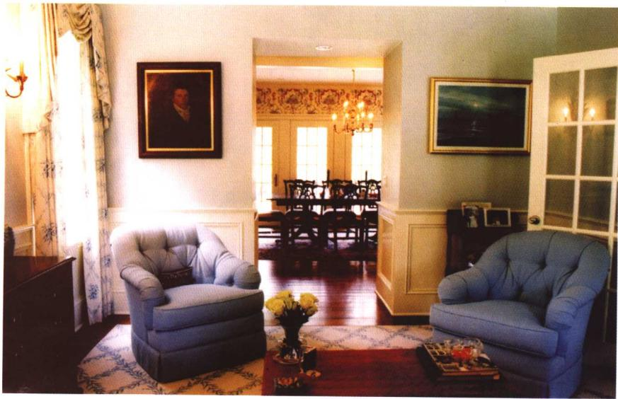
木墙裙在潮湿墙面需做防潮处理。在与踢脚线连接处可每隔1m钻一个气孔。
