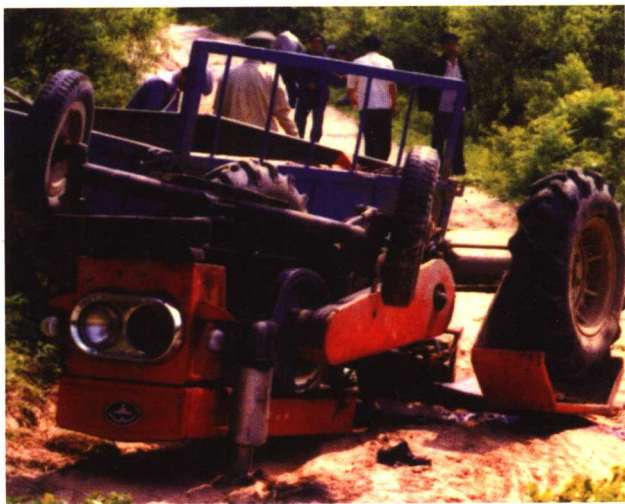
拖拉机下坡时,严禁空档滑行和中途换挡。
