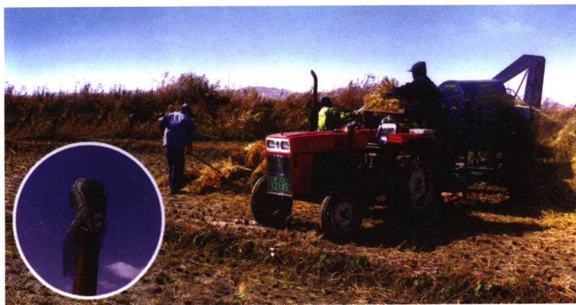
驾驶、操作人员应当告知参加农业机械作业的辅助人员本项作业的安全操作规则。拖拉机打场,必须安装防火装置,以防发生火灾。
