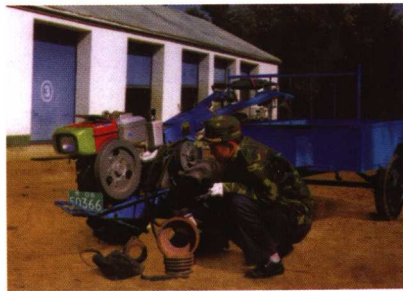
拖拉机严禁加大皮带轮的办法提高行驶和作业速度,不能改变拖拉机的登记结构。
