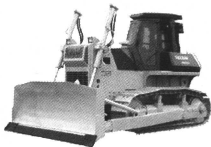
图 1-5 三一重工的 TQ230H 静液压驱动履带式推土机
