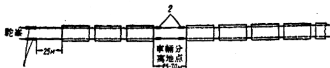
圖6. 防護車輛時配置制動鐵鞋的示意圖：
