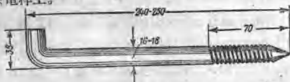
圖9 電纜分線電桿步桿釘
