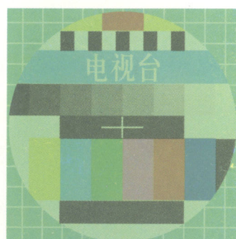
图 11 标准测试图偏绿色
