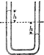
設管之截面積為  $S$ ，液體之密度為  $\rho$ ，液柱兩端與平衡位置之距離各為  $h$ ，液柱當時所受之加速度為  $a$ 。
