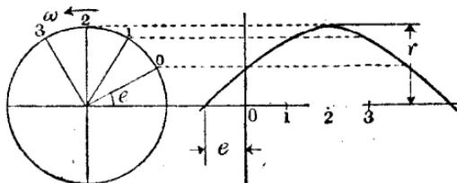
圖中所示，乃  $y = r \sin(\omega t + e)$  之圖形。
