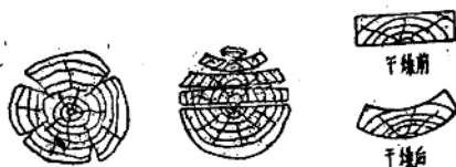
图 3-2 木材的翘曲与裂缝
