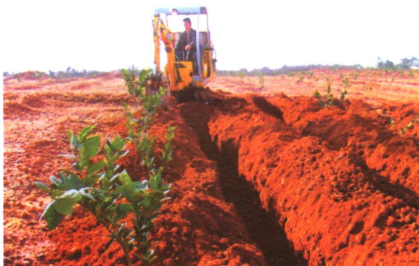
采用小型挖掘机进行 美国纽荷尔脐橙园深 翻扩穴作业
