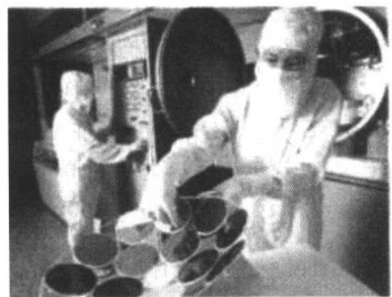
图0-13 芯片加工中的溅射工序
