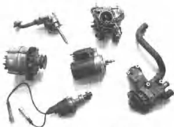
图 1-3 发动机外部附件的拆卸
