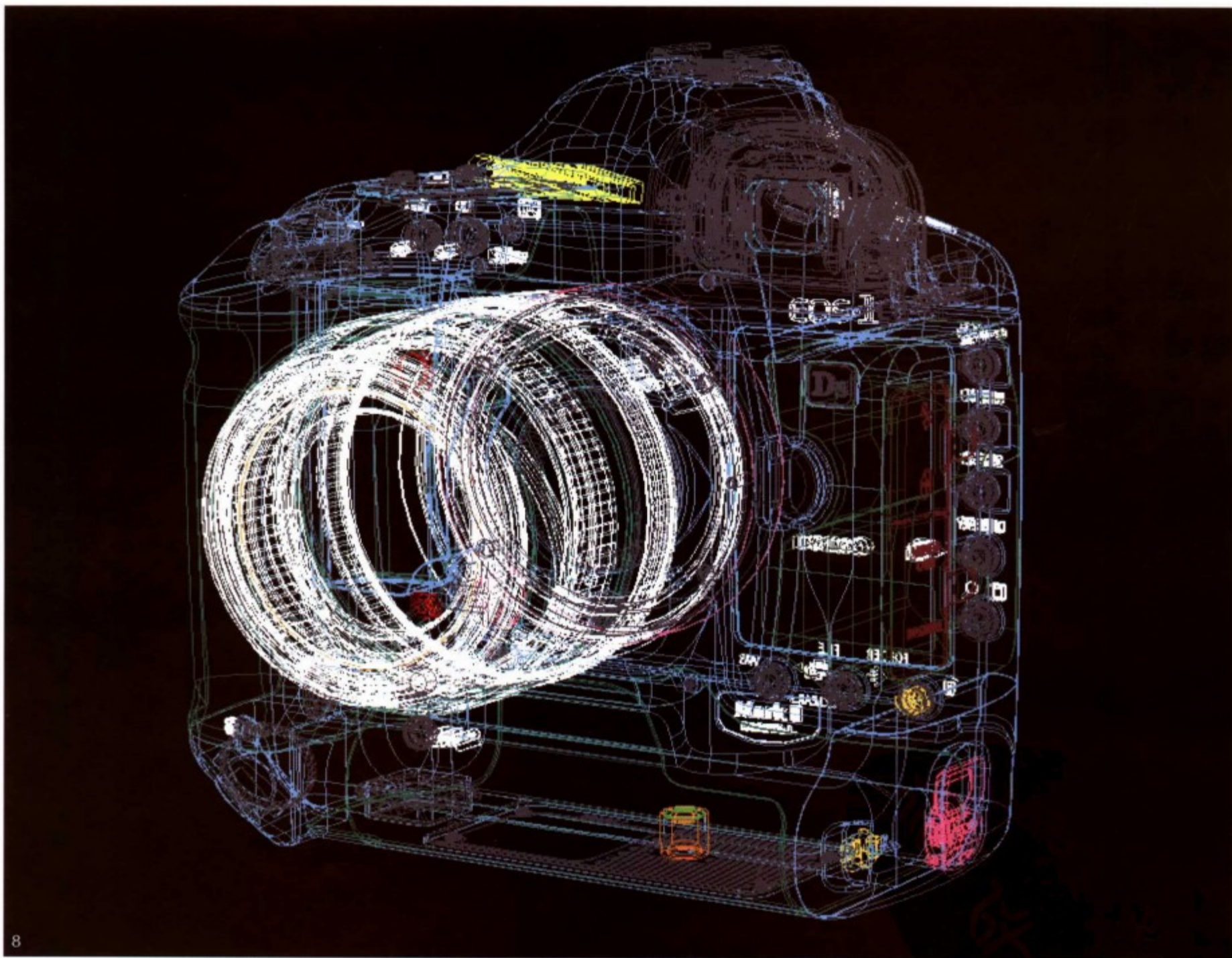
根据概念草图建立的三维CAD模型
