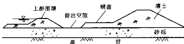
图3 有上游围堰时铺盖之布置
