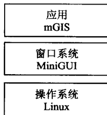
图 2 图形用户界面系统的结构
