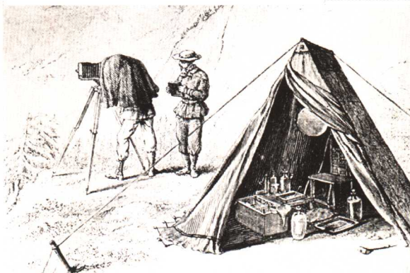
1870年火棉胶技术时代的外拍摄影设备重量大约70~120磅。
