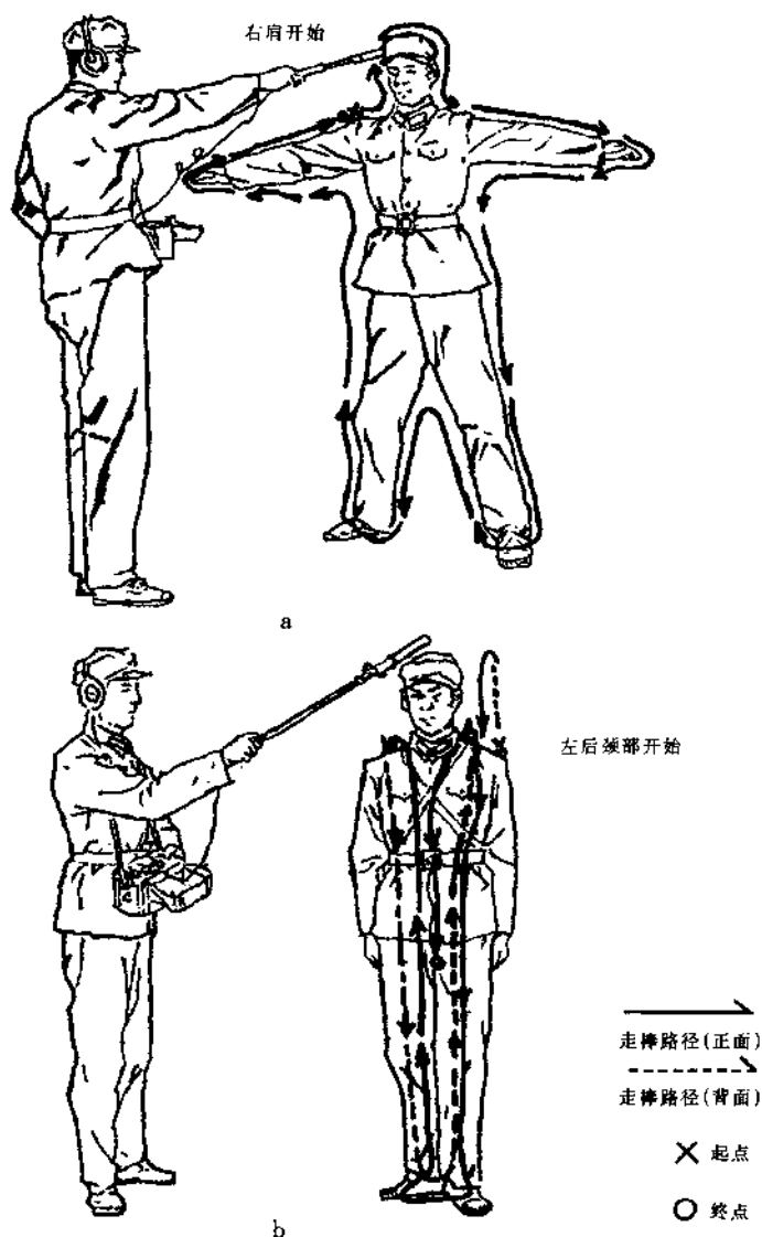
图 3-3 人员体表沾染检查的顺序
