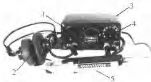
1. 电池盒 2. 耳机 3. 操纵箱 4. 量程开关 5. 探头
