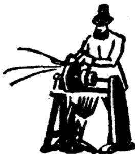
要使踏板能带动车床连续转动，在踏板和曲轴之间应该装上一个连杆。连杆可以象手摇动一个曲柄一样地摇动车床上的曲轴。
