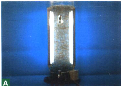
A 应用光生物反应器（20~100L）大规模培养条斑紫菜自由丝状体，可进行控光控温系统调控紫菜自由丝状体发育
