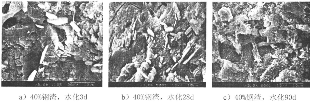
图5 掺钢渣水泥水化产物的 SEM 形貌(×3000)
