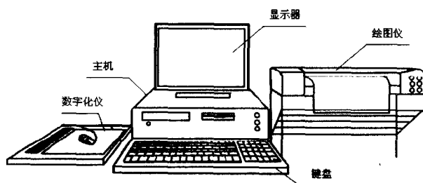
图 1-3 微型计算机绘图系统硬件设备的简单配置
