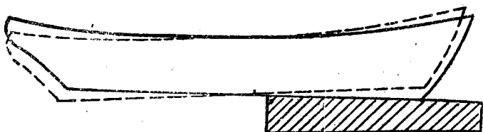
图10 船体下水时重力力距大于浮力力距
