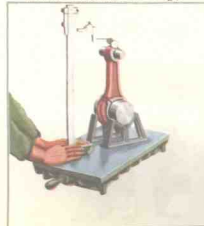
测量连杆的弯曲度，大小头孔中心线的平行度在 150 毫米长度内应 < 0.05 毫米
