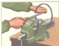
将活塞环扩张到恰能过活塞顶部各人环槽
