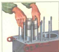
各道活塞环的闭合间隙应用锉刀修至规定尺寸，最大不应超过 2 毫米
