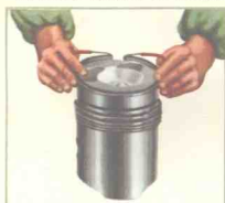
装配活塞时，应按此法检查各道活塞环与槽的不同轴向间隙
