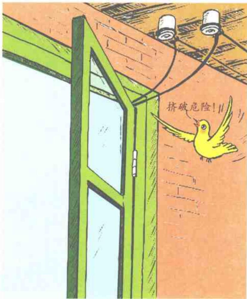
电线通过门窗缝穿接，容易挤破，造成漏电。
