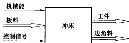
图 2-3 冲床系统的功能分析
