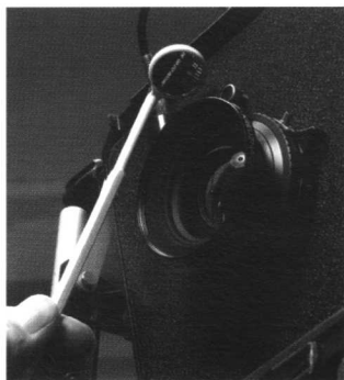
用牙科小镜来反射镜头的光圈速度参数
