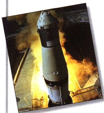
↑ 20世纪60年代和70年代里，美国向月球发射过“土星—V”系列运载火箭。“土星—V”系列运载火箭迄今为止仍是最大的巨型运载火箭，其起飞重量3000吨，高110米。
