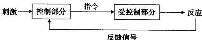
图 1-3 反馈控制系统示意图
