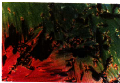
液晶织物图案 近晶 A 相焦锥扇形织构化合物(92.9℃, 降温)
