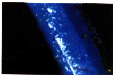
液晶织构图案: 蓝相织构化合物(127.2℃, 升温)
