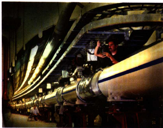
布鲁海文相对论堆 重离子对撞机 中全部 为超导磁体励磁。
