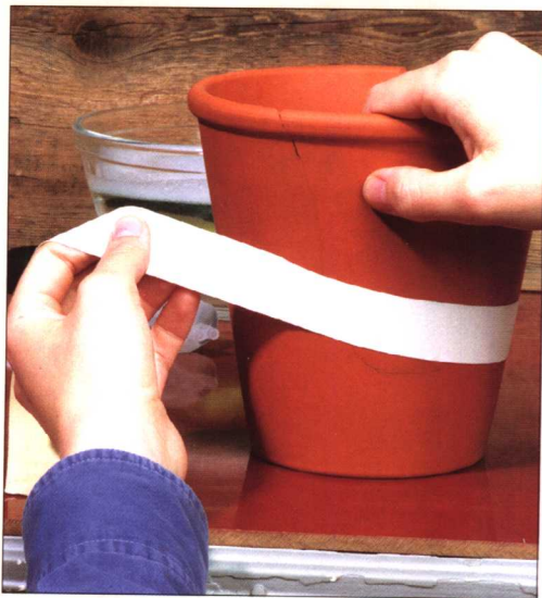
修补破容器。 用环氧树脂修补黏土容器。将碎片洗干净，用环氧树脂粘上，然后用胶带捆紧，直到胶干。
