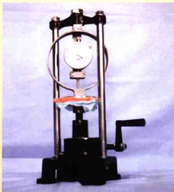
测定系水率用的改装土壤允许膨胀压缩仪
