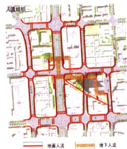
彩图23 人行网络系统与地铁站的无缝拼接示例—龙翔站
