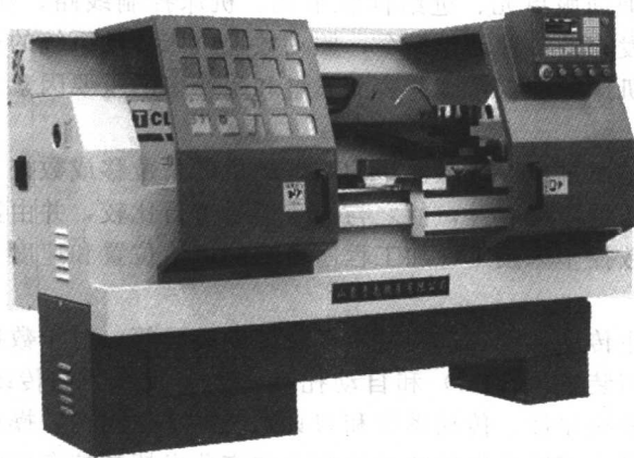
图 1-1 数控车床 CK6136 外形
