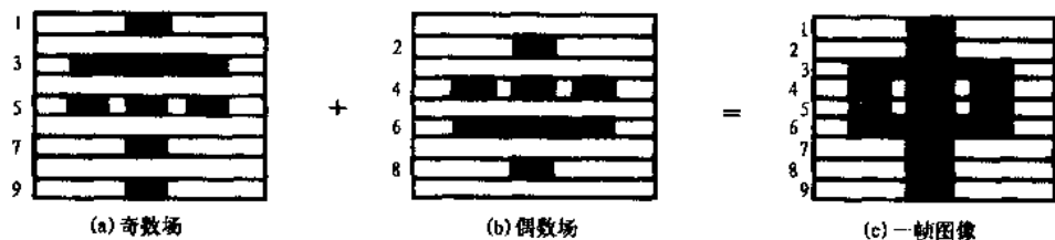
图 1-4 隔行扫描重现图像的原理
