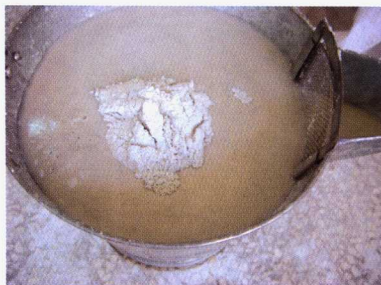
3. 俗话说,“石膏露头,不稀不稠。”一直撒到石膏粉从水面上露出来就基本合适了。
