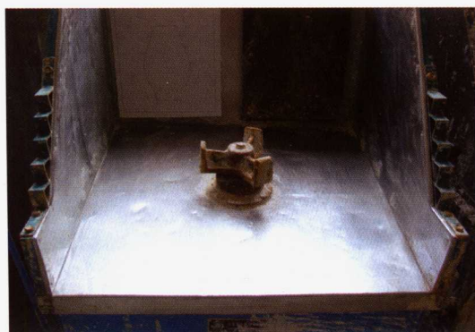
3. 露出了轮盘，轮盘的基本结构就是有三个爪状支臂。
