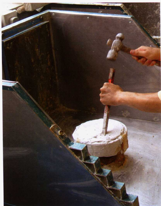
2. 用工具把轮盘上的废石膏清理掉。
