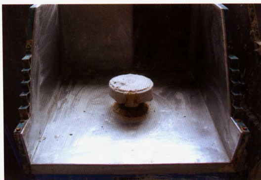
1. 首先把车模车台面清理干净。车模车轮盘上的废石膏还没有清理。
