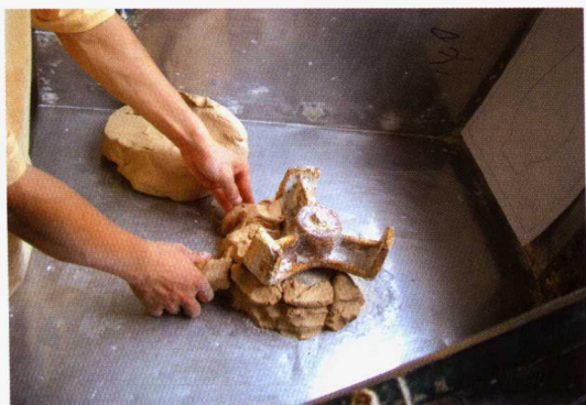
4. 用泥巴填充轮盘下面和三个支臂之间的空隙。
