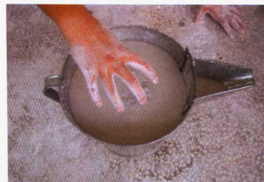
5. 用手或者搅拌棒进行匀速的搅拌。速度不要太快,以免激起太多的气泡。手的动作如图,称为虎爪式。
