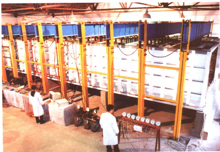
南水北调中线工程刁河渡槽结构模型试验
