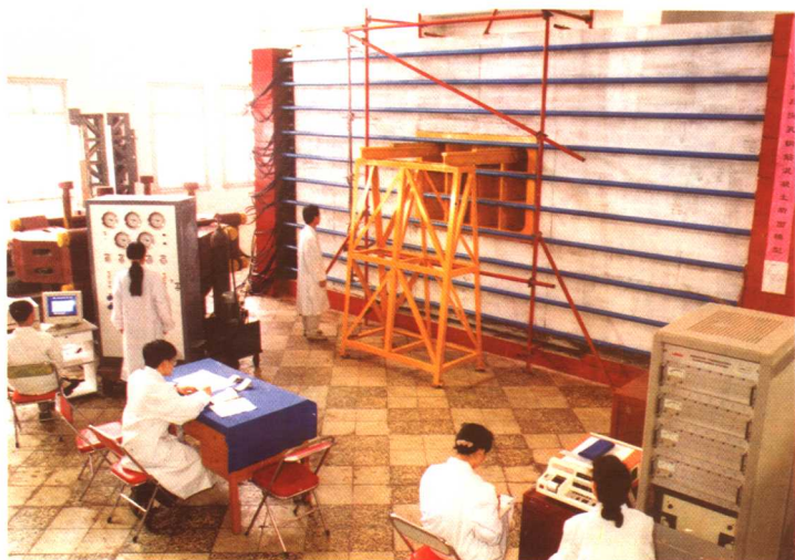
三峡溢流坝深孔孔口结构模型试验(大比尺)
