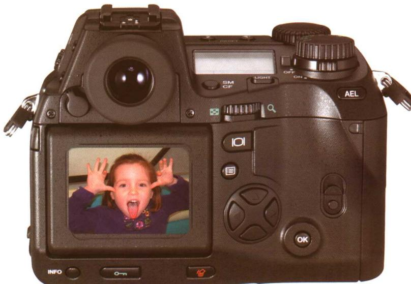
数码照相机的最大优点之一，就是在曝光完成之后马上可以看到拍摄的结果，而且在下载到计算机之前，你可以反反复复地重放浏览这些影像。这样，你就可以判断拍摄的曝光量和被摄对象的姿势是否符合要求。有了LCD监视屏的预览功能，你就可以删除不想要的影像，以便在存储卡上腾出更多的空间来保存后面拍摄的影像。
