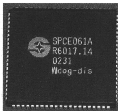
图 1-6 SPCE061A PLCC84 实物图
