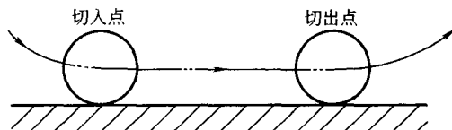
图 1-15 圆弧线进、退刀方式
