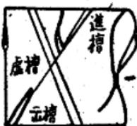
这样使原来在沟槽內的紗线由于虛槽的抗噏合的作用，促使筒子的本身造成輕微的位移。这样有助于防叠的作用。为了使虛槽达到槽筒周围的 $\frac{1}{4}$ ，并且把出槽基线（即底线）根据原来卷繞角的角度向槽筒的中間移动 $3^{\circ}$ 。这样易于入
