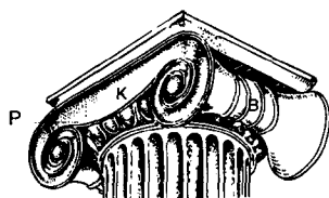
爱奥尼克式柱头 P 柱垫, B 装饰环带檐槽
